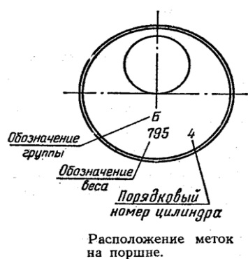
Рис. 7.4. Расположение меток на поршне.
