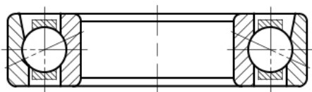
Рис. 5.3. Схема радиально - упорного подшипника.
